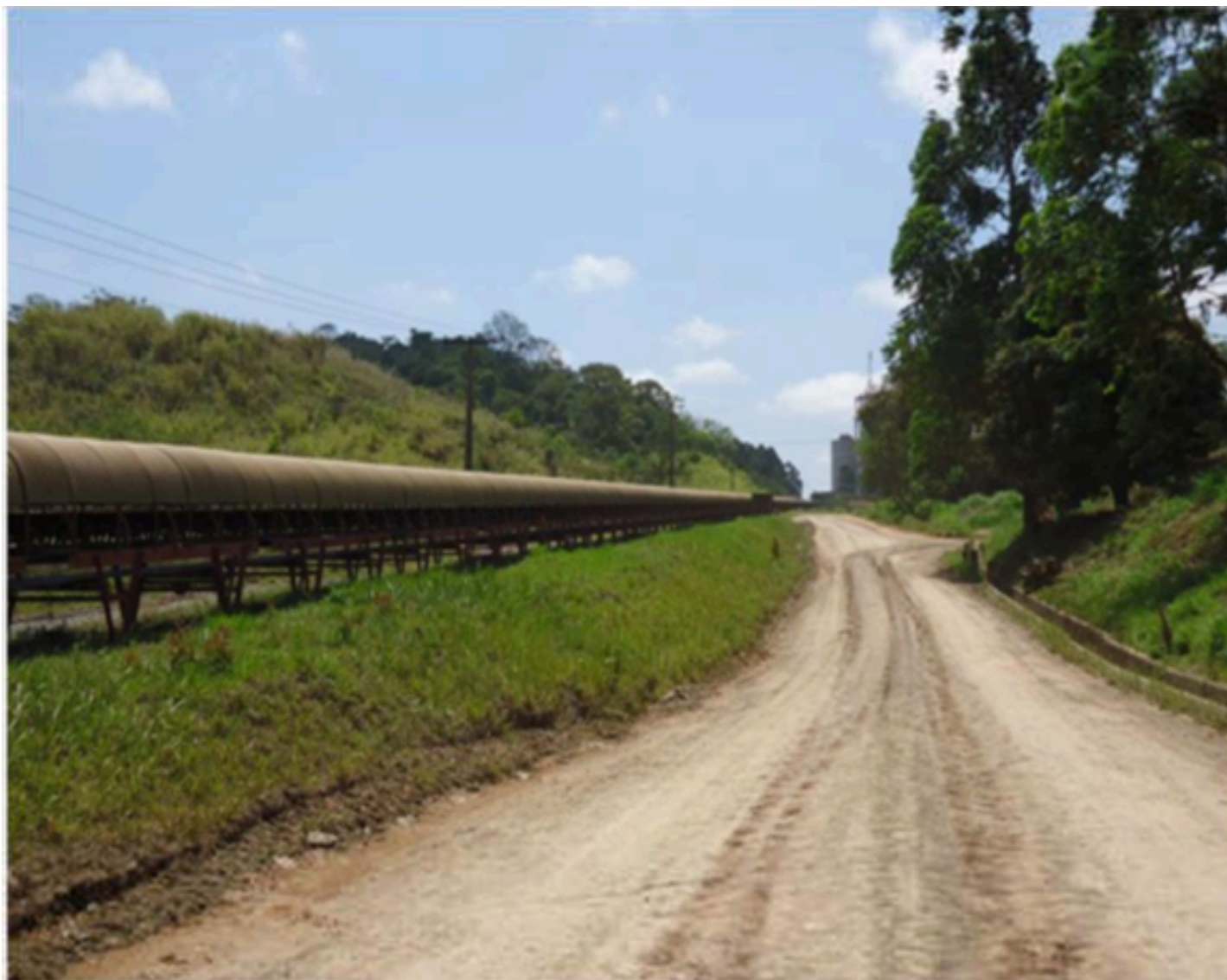
Figura 09. Transportador de correias de longa distância da Cimento Tupi (Fonte: Cimento Tupi)
