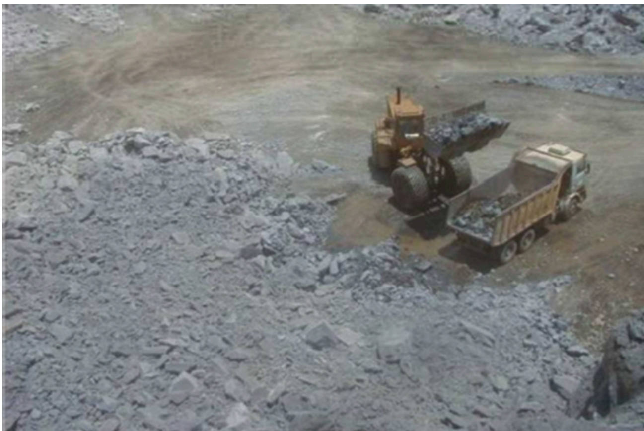
Figura 06. Pá carregadeira realizando a operação de carregamento do calcário.
